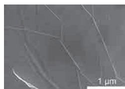
白金陰極を覆う水熱電解法により合成されたグラフェンの SEM (走査型電子顕微鏡) 像 (グラフェンと白金の熱膨張係数の差に由来する「しわ (wrinkle)」が見える)
